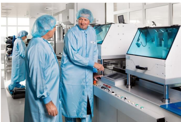
Abb. 3 Arbeitsplatz zur Herstellung der Multilayer PICMA® Aktoren im Reinraum der Klasse ISO 6 bei PI Ceramic
